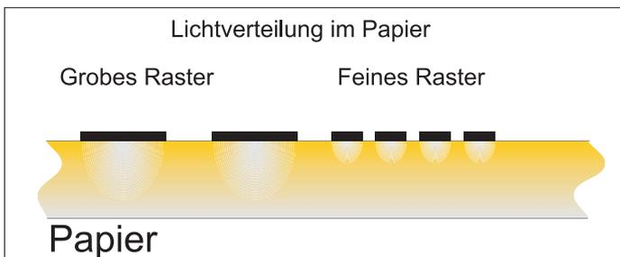
**Abbildung 5: Lichtverteilung an Punkten unterschiedlicher Rasterweite aber gleichen Rastertonwertes.**
