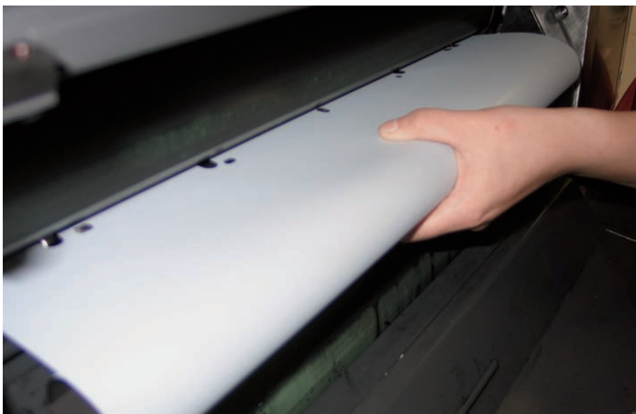
Einspannen der Druckplatte: Ein für eine Aluminiumplatte »tödliches« Plattenhandling kann bei einer Kunststoffplatte durchaus sinnvoll sein.
