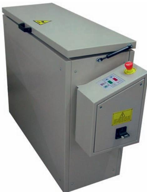
Abb. 3: Colorgate Curing Unit (Einbrennofen) zur Aushärtung der Tintenschicht auf der Druckplatte.
