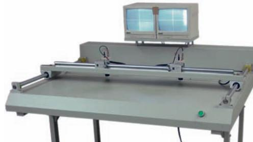
Abb. 5: Jorg-Videostanze, eingesetzt an der Hochschule Mittweida zur registergenauen Plattenstanzung.
