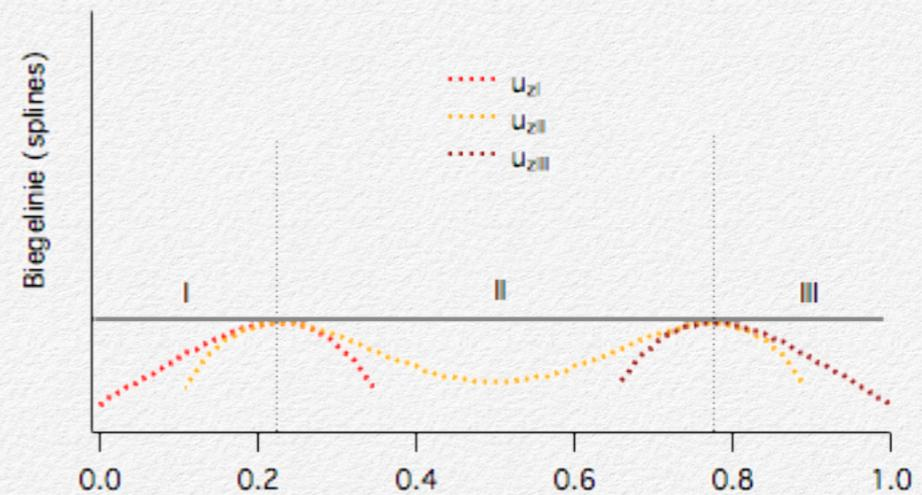
Die mittlere Durchbiegung ist in diesem Fall um den Faktor 65.3 mal kleiner als der entsprechende Wert bei Lagerung an den Enden des Biegeträgers.
