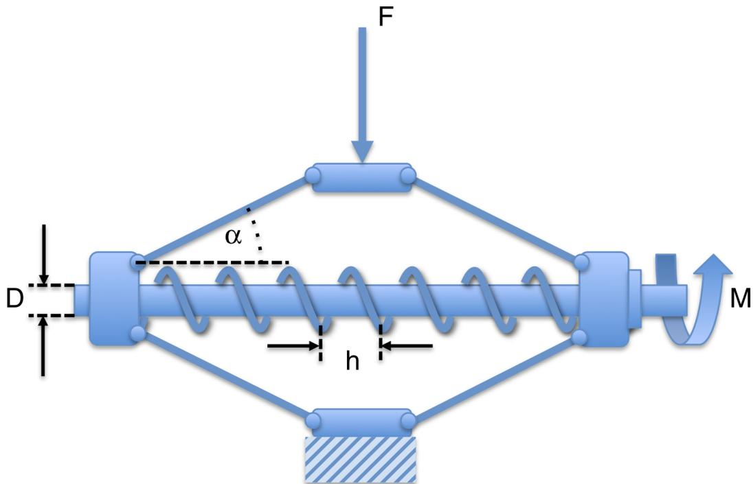
Welches Moment  $M$  ist notwendig, um mit einem Scherenwagenheber (s. Skizze) bei einem Öffnungswinkel  $\alpha$  ein Objekt mit der Gewichtskraft  $F$  anzuheben?
