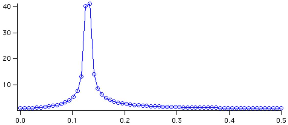
Erst die Filterung der diskreten Messwerte mit dem Hanning-Fenster:
