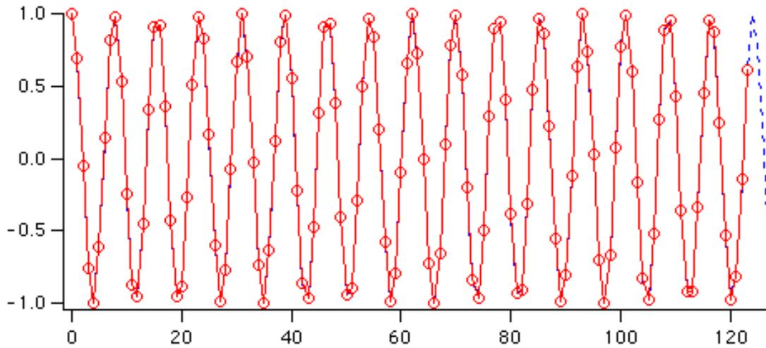
Der rote Kurvenzug entspricht einem periodischen Audiosignal. Das zugehörige Amplitudenspektrum gibt die einzelne Cosinusschwingung deutlich wieder.
