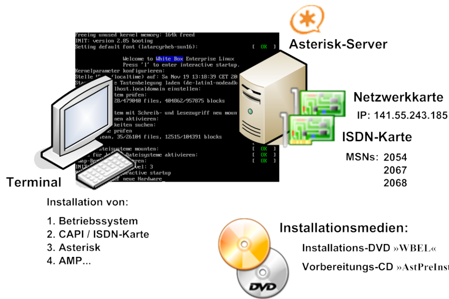
Abb. 1: Versuchsumfeld während der Installation
