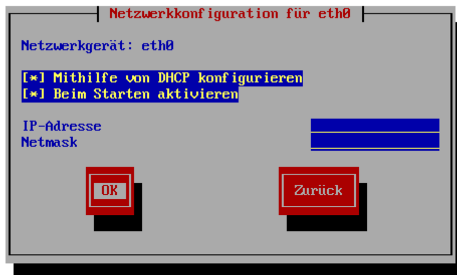
Abb. 8: Netzwerkkonfiguration (IP-Adresse, Subnetzmaske, weiter mit OK)
