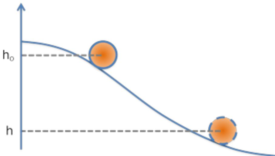
Die Energiebilanz beim Start beinhaltet nur einen Anteil an potentieller Energie, zu der infolge der Bewegung die kinetische Energie des Schwerpunktes hinzukommt sowie die Rotationsenergie des abrollenden Körpers mit dem Massenträgheitsmoment  $J_S$ :
