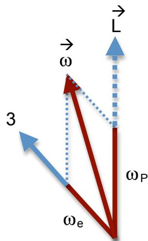
Der erste Summand im obigen Ausdruck steht für die Projektion der Winkelgeschwindigkeit  $\vec{\omega}$  auf die Achse des Drehimpulses  $\vec{L}$  (s. Skizze).
