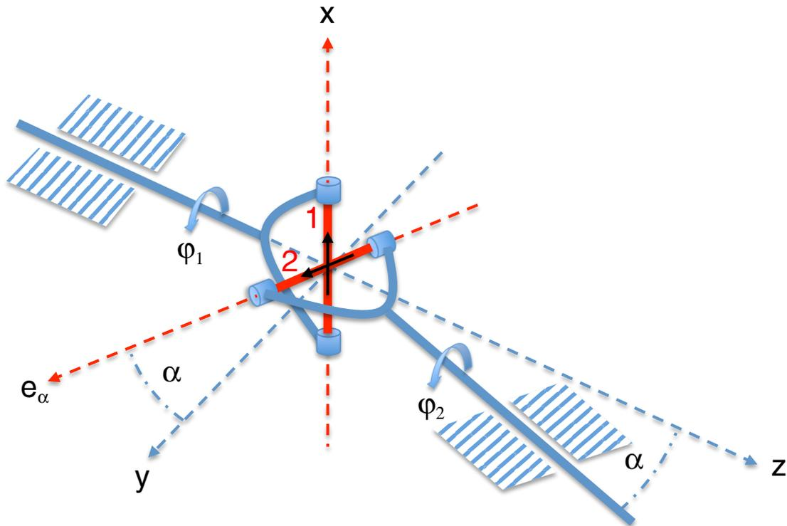
Die beiden Achsen des Kardangelenks spannen die (y,z)-Ebene auf; sie schließen den Winkel  $\alpha$  ein. Die Verkippung der Achsen untereinander (s. Skizze) beschreibt der Einheitsvektor:
