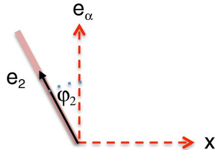
Die Bedingung nach Orthogonalität beider Streben des in der Skizze rot markierten, starren Verbindungskreuzes
