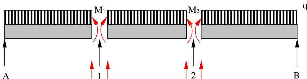
Die Formänderungen des Ersatzsystems müssen kompatibel zu denen des Durchlaufträgers sein; es darf kein Knick in der Stabachse auftreten. Die Tangenten an die Biegelinien  $u_z(x)$  in benachbarten Komponenten müssen über jeder Innenstütze deckungsgleich sein.
