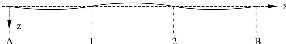
Alternativ ließen sich die Stützkkräfte der Innenstützen auch direkt über die Superposition der Biegelinien folgender Einzelbelastungen unter Beachtung der Verträglichkeiten in den Durchbiegungen an diesen Lagern ermitteln:
