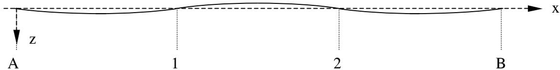
Die Formänderungen der auf Biegung belasteten Teilträger ergeben sich aus der Superposition (additiven Überlagerung) folgender Einzelbelastungen:
